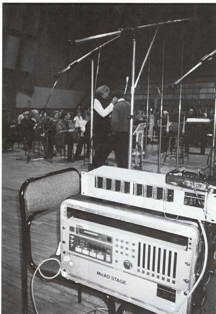
上からバックアップの「ソニーTCD-D6」、「スチューダーD19リモート」、「タスカムDA-78HR」、「D19 MicAD STAGE」(8chヘッドアンプ&ADコンバーターTDIFインターフェース付き)
